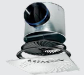
**Freihängende Dralldurchlässe mit Randverbreiterung** zur besseren Ausnutzung des Coanda-Effekts bei Montage in offenen Decken.
