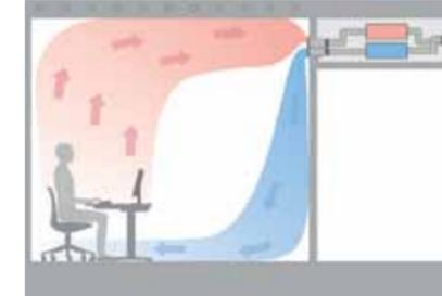
Das Prinzip der Quelllüftung basiert auf der impulsarmen Lufteinbringung und den natürlichen Auftriebsströmungen im Raum, die an vorhandenen Wärmequellen wie Personen, elektrischen Geräten und Beleuchtungskörpern entstehen.
