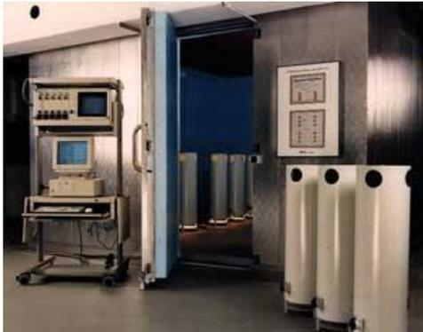
Diese Einrichtung dient der normgerechten Bestimmung von Kühlleistungen passiver und aktiver Wasserkühlsysteme nach den Normen DIN EN14240, DIN EN14518 und DIN EN15116. Hier werden Neuentwicklungen vorangetrieben, Katalogdaten ermittelt und für Großprojekte nach Kundenwunsch Messungen als Leistungsnachweis durchgeführt.
