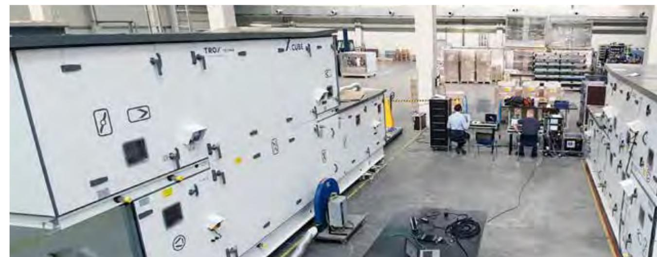
Eine ebenfalls nachhaltige Entwicklung, die sonst übliche Reisen und Kontakte ersetzt und CO<sub>2</sub> einspart, ist der **Online-Factory-Acceptance-Test**. Der sogenannte FAT ist die von Kunden im Herstellerwerk durchgeführte Abnahme von Geräten, bei der alle Leistungskriterien geprüft werden. Auch bei TROX werden die Tests vor Auslieferung auf Kundenwunsch durchgeführt.
