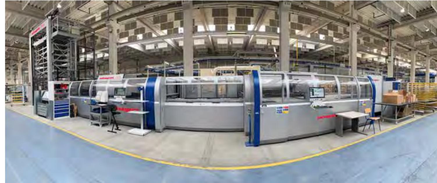
Zudem haben wir im Jahr 2020 bereits weitere nachhaltige Technologieoptimierungen geplant – wie eine Kurzrohranlage, die die Arbeitsschritte Runden, Schweißen und Rohrendbearbeitung in einer kompakten Fertigungslinie miteinander verknüpft. Die erwartete CO<sub>2</sub>-Einsparung beträgt hier mehr als 34.000 kg pro Jahr.
