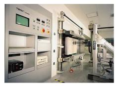
Diese Prüfmethode gilt für Schwebstofffilter (HEPA) und Hochleistungs-Schwebstofffilter (ULPA) im Bereich der Raum- und Prozeßlufttechnik, z.B. in der Reinraumrechnik.
