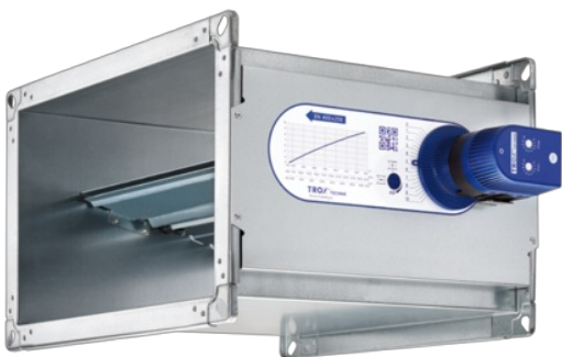
Konstantvolumenstromregler EN für höhere Volumenströme 40 - 3.360 l/s 144 - 12.096 m 3 /h B: 200 - 600, H: 100 - 600 mm \Delta p : 50 - 1.000 Pa Gehäuse-Leckluftstrom gemäß EN 1751, Klasse C
